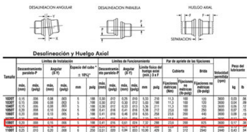
Figura 3. Límites de funcionamiento del acoplamiento utilizado.
