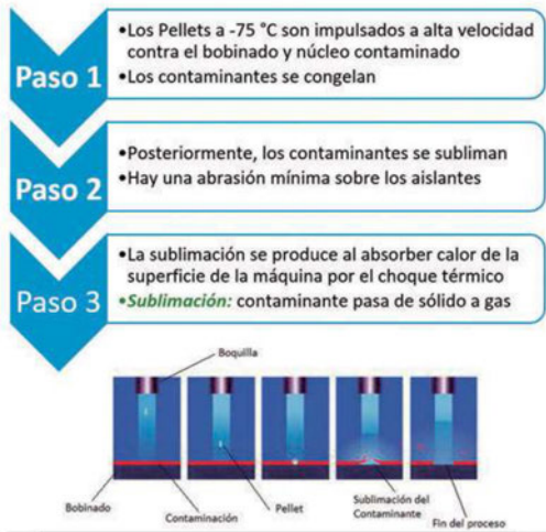
Figura 4. Explicación del proceso de limpieza criogénica.
