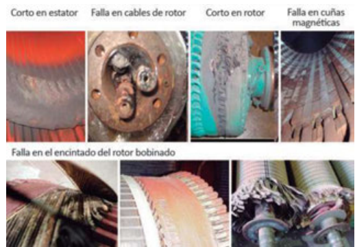
Figura 4. Fallas eléctricas en aerogeneradores.
