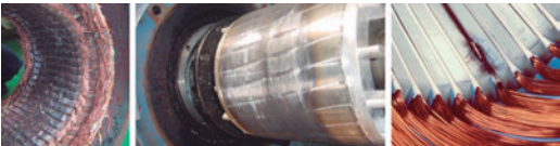
Figura 5. Daños típicos en núcleos laminados.
